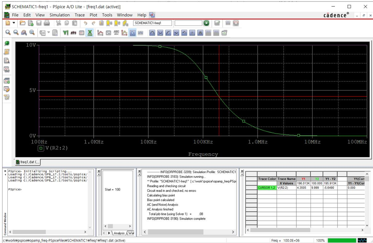
위와 같은 주파수 응답 그래프에서 커서 기능을 이용하여 주파수에서의 전압 크기를 읽어서 실습 교재의 표와 -3dB 주파수 값을 채웁니다. 다른 소자 값에 대한 시뮬레이션도 유사하게 진행합니다.
