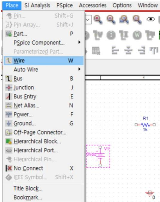
연결하려는 부품의 단자 끝에 마우스 커서를 놓고 클릭을 한 후 마우스를 끌고 가면 마우스의 경로에 따라 전선이 그려지며 연결하려는 다른 부품의 단자 끝에 도착하면 아래와 같이 빨간 원이 나오며, 이때 마우스를 다시 클릭하면 전선이 연결 됩니다. 이 작업을 모든 전선에 대해서 반복합니다. Wire 그리기 작업을 끝내려면 오른쪽 버튼을 누르고 End Wire를 선택합니다.
