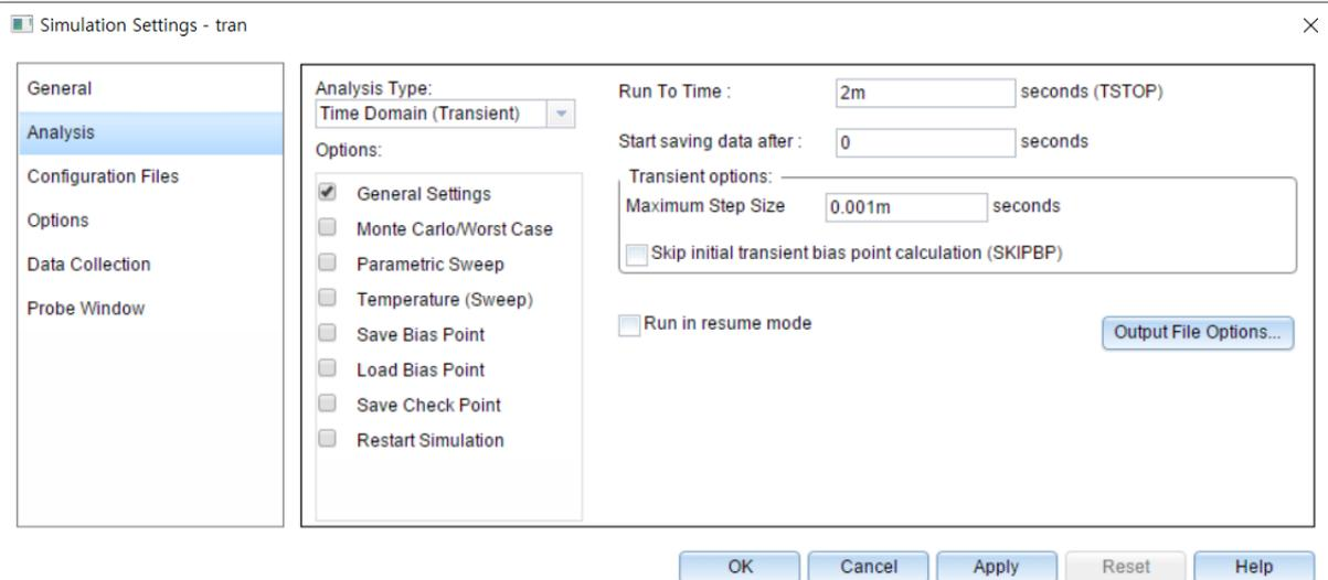
Maximum Step Size는 빈칸으로 두어도 상관 없으나, 그래프가 매끄럽지 않을 수 있습니다. 위의 그림과 같이 1 micro sec으로 설정하면 컴퓨터 성능에 따라 계산에 오래 걸릴 수 있으나 다음 그림과 같이 매끄러운 그래프를 얻을 수 있습니다.
