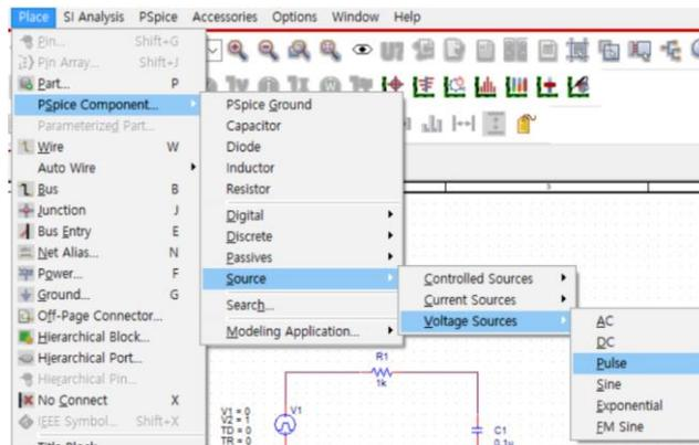
아래의 그림은 실습 교재의 첫째 회로입니다. Capacitor를 선택하여 그린 후 값을 0.1u 라고 입력합니다. 이와 같이 입력하는 것은 커패시터의 값  $0.1\mu F$  입니다. 실습 교재에서 입력 함수의 크기는 1V, 주기는 2msec라고 하였으므로, Pulse Voltage Source 의 각 값들은 아래 그림과 같이 입력합니다. V1은 초기 전압 값이므로 0, V2는 Pulse 함수의 크기 전압이므로 1입니다. TD는 delay time, TR은 rise time, TF는 falling time이므로 모두 0을 입력합니다. PW는 pulse의 폭, PER은 주기이므로 각각 1m, 2m를 입력합니다. 커패시터의 전압을 관찰하기 원하므로 Voltage Marker를 넣습니다.
