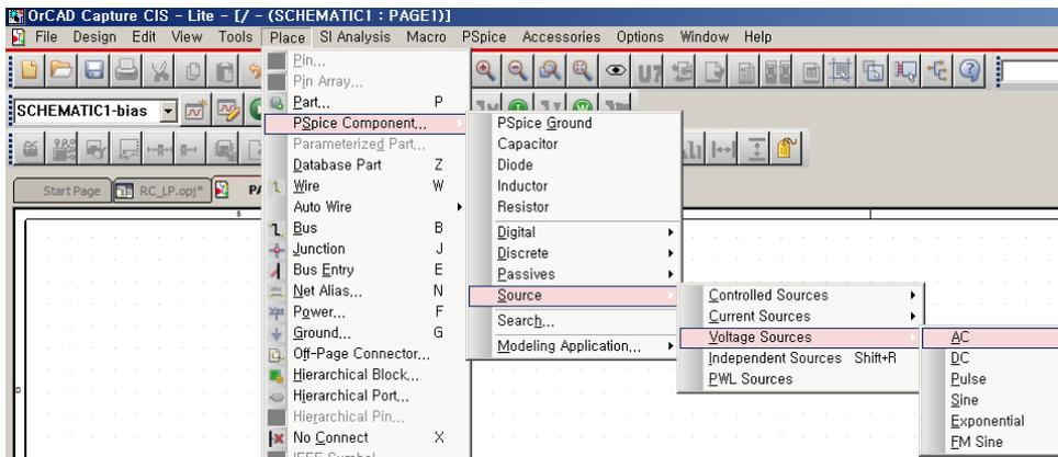
그리고 회로를 그린 후, PSpice profile은 다음 그림과 같이 설정합니다. Analysis type은 AC Sweep/Noise 이며, 시작 주파수와 끝 주파수, 그리고 시뮬레이션 포인트를 입력한다. 이때, Start Frequency, End Frequency는 측정하려는 수치에 맞게 적절히 선택합니다. 또한 Points/Decade는 크게 설정할수록 부드러운 그래프를 그릴 수 있으며, 계산 량은 증가합니다.
