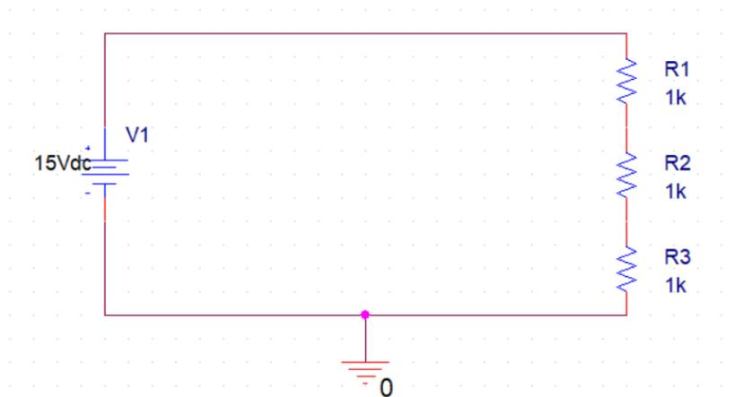
이 회로에서는 전압을 측정해야 하므로 아래와 같이 Voltage Marker를 선택하여 회로의 측정 위치에 설정한 후 시뮬레이션을 실행합니다.
