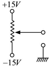
실제 회로에서는 potentiometer를 돌려서 가변 전압을 쉽게 얻을 수 있으나 시뮬레이션에서는 그렇게 하는 것이 매우 번거롭습니다. 따라서 시뮬레이션에서는 위와 같은 potentiometer 회로 대신에 DC voltage source를 이용합니다. PSpice에서 DC voltage source의 전압은 파라미터를 변경하여 간단하게 변경이 가능합니다.
