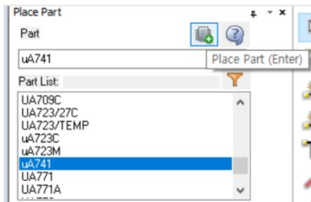
교재의 실습을 하기 전에 연습으로 아래와 같은 inverting amplifier 회로를 그립니다. 이때, OP amp의 7번 핀에는 15Vdc가 4번 핀에는 -15Vdc가 연결되어야 합니다.
