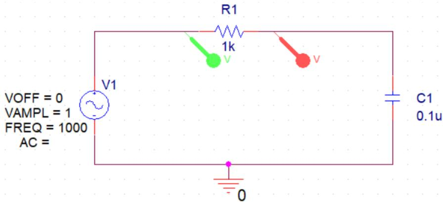
또한, 이 실험에서는 입력되는 sine wave와 커패시터 전압을 비교해야 하므로 위의 그림과 같이 Voltage Marker를 2개 설치합니다. Simulation profile은 아래와 같이 입력합니다. 특히 시뮬레이션 시간은 입력 sine wave의 2개 주기인 2msec로 합니다. 결과 관찰 시에 과도기가 지난 후 수치를 읽어야 하므로 2개 주기로 시뮬레이션을 합니다.
