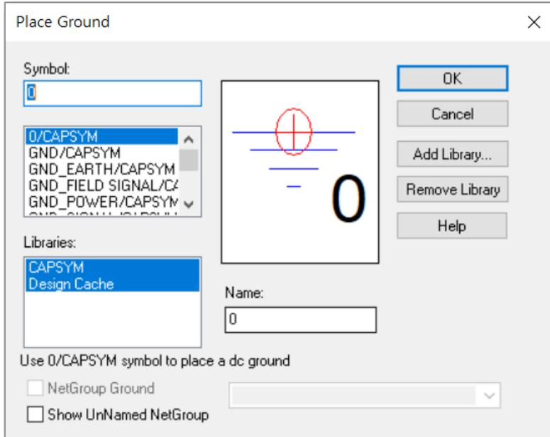
위의 화면에서 OK를 누르고 나면 아래와 같이 마우스 커서에 Ground 표시가 따라 다니며 한 번 클릭할 때마다 Ground가 회로에 하나씩 그려집니다. Ground는 하나만 필요하므로 반드시 한번만 클릭하십시오. 만약 실수로 여러 개 그린 경우, 나중에 지울 수 있습니다. Ground 그리기를 끝내려면 오른쪽 버튼을 누르면 아래와 같은 메뉴가 나오며 여기서 End Mode를 선택하면 Ground 그리기를 끝낼 수 있습니다.
