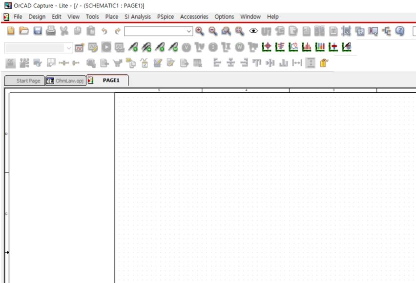
위의 화면은 회로를 그리기 위한 회로 그림 판입니다. Ohm의 법칙을 시험해 볼 수 있는 간단한 회로를 그려 보기로 합니다. 가장 먼저 아래와 같이 Ground를 넣습니다.
