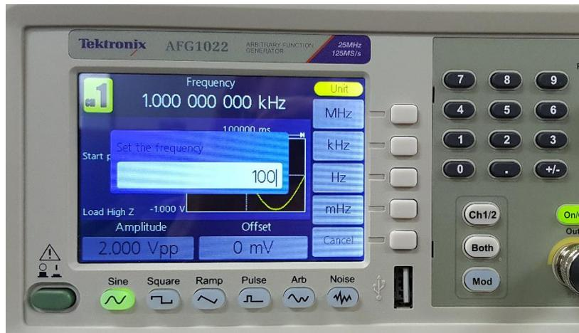
주파수 선택이 완료되면 다음 그림과 같은 화면이 나오며, 이 상태에서 Ampl 표시 오른쪽의 버튼(위에서 3번째 버튼)을 누르면 신호의 크기 선택이 가능하다. 이는 신호의 크기를 선택하는 메뉴이며, 신호의 크기는 두 가지 방법으로 선택이 가능하다. 첫 번째 방법은 Amplitude와 Offset으로 선택하는 방법이며 Amplitude는 peak-to-peak 전압의 크기로 선택한다. Offset은 DC 전압 즉 평균치를 의미한다. 두 번째 방법은 신호의 최대값(High)과 최소값(Low)으로 선택하는 방법이다. Amplitude 오른쪽의 버튼은 한번씩 누를 때 마다 이 두가지 방법이 교대로 선택된다. 아래의 그림은 Amplitude와 Offset으로 선택된 화면을 보여준다.
