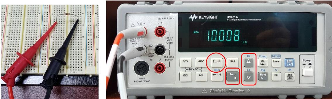
멀티미터를 이용하여 측정할 때, 측정 값의 범위를 자동으로 설정하는 방법과 수동으로 설정하는 방법이 있다. 멀티미터 전면의 Auto 키를 한번씩 누를 때 마다, 자동에서 수동으로 혹은 수동에서 자동으로 변경이 된다. 자동으로 설정되면 화면에 AUTO 라는 문자가 표시된다. 위의 그림은 자동으로 설정된 화면을 보여준다. 수동 설정에서는 Hi 와 Lo 버튼을 눌러서 값의 범위를 크게 설정하거나 작게 설정할 수 있다. 자동으로 설정되어 있을 때 Hi 혹은 Lo 버튼을 누르면 수동으로 변환된다. 자동 설정을 사용하면 편리하기는 하지만 때때로 정확하지 않을 수 있다. 따라서 정확한 측정을 위해서는 수동 설정의 사용을 권장한다.
