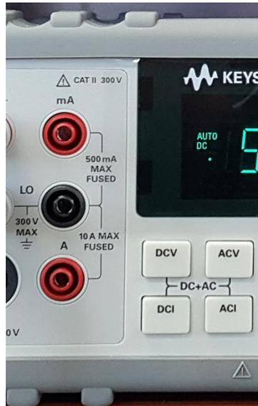
전류 측정을 위해서 검은색 프로브는 검은색 단자에 꼽지만, 빨간색 단자는 측정하려는 전류 값의 범위에 따라서 적절한 단자에 꼽아야 한다. 실험실에서 실시하는 실험의 전류값은 대부분 500mA 이하 이므로, 500mA 단자를 사용하는 경우가 많다. **만약 측정하려는 전류값이 최대값을 초과할 경우 멀티미터의 퓨즈가 손상이 되므로 주의를 필요로 한다.** 따라서 전류측정을 위해서 멀티미터를 연결하기 전에 전류의 값을 대략적으로 계산하여 최대 전류값을 초과하지 않는지 확인할 필요가 있다.
