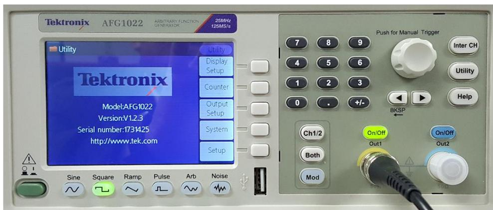
위의 Utility 화면에서 Output Setup 버튼을 눌러 선택하면 다음 그림과 같은 화면이 나온다. CH1Load 옆의 버튼을 누를 때 마다 값이 바뀌며, 이 값이 High Z 가 되도록 설정한다. 설정이 끝나면 Utility 버튼을 눌러서 원래의 화면으로 돌아온다.
