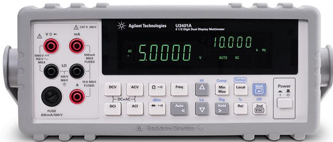
멀티미터를 이용해서 저항, 전압, 전류 등을 측정하기 위해서는 다음 그림과 같은 프로브(probe)를 멀티미터의 전면 패널에 꼽는다. 통상적으로 검은색 프로브는 전면 패널의 검은 단자(COM)에 꼽으며, 빨간색 프로브는 빨간색 단자에 꼽는다. 단, 같은 색 단자가 여러 개 있으므로 측정하려는 값, 또는 신호에 따라서 적절한 단자에 꼽는다.
