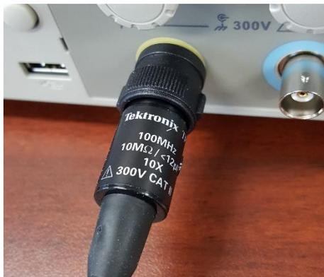
사용 중인 프로브의 배율 값에 따라서 Probe 배율을 설정한다. Probe 표시 오른쪽 버튼을 누르면 아래 그림과 같은 Probe 배율 선택 메뉴로 들어간다. 이 메뉴에서 Multipurpose 다이얼을 돌리면 배율을 변경할 수 있으며, Multipurpose 다이얼을 누르면 배율 선택이 결정된다.
