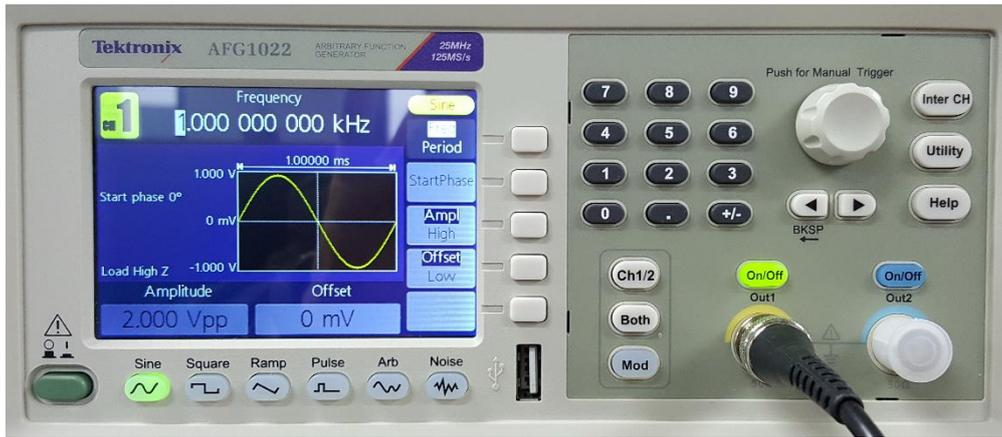
간단한 예로서 100Hz의 sine wave를 발생시켜본다. 발생시킬 sine wave의 peak-to-peak 전압은 2V이며 offset은 0V로 한다. 즉 sine wave의 가장 낮은 전압이 -1V 가장 높은 전압이 1V가 되도록 한다. 먼저, 위의 그림과 같이 sine 버튼이 선택되어 버튼 램프가 점등 상태인지 확인한다. 다음, 주파수를 선택하기 위해서 화면 옆의 5개의 흰색 버튼 중 Freq/Period 라는 표시의 오른쪽에 있는 버튼(가장 위의 버튼)을 누른다. 이 버튼은 같은 버튼을 한번씩 누를 때 마다 입력 방법이 주파수(Freq)와 주기(Period)가 교대로 바뀐다. 위의 화면은 주파수가 선택된 화면을 보여준다. 주파수 선택 상태에서 숫자 패드의 숫자를 누르면 아래 그림과 같이 숫자 입력 화면으로 바뀌며, 이 화면에서 숫자 100을 누른 후, Hz 표시 오른쪽의 버튼을 누르면 주파수 선택이 완료된다.
